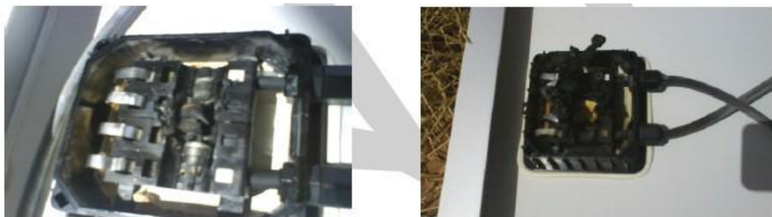
接线盒引线端子烧毁
