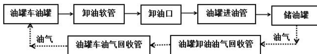
图2.4-3 汽油卸油工艺流程框图
