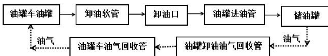
图2.4-4 汽油卸油工艺流程框图
