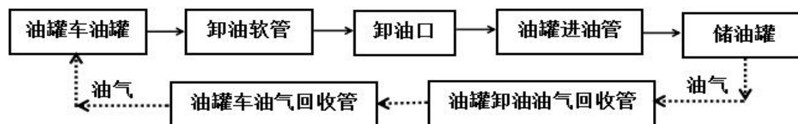
图 2.4-3 汽油卸油工艺流程框图
